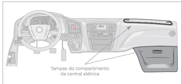
A central elétrica contém todos os relés e fusíveis que compõem o sistema elétrico, e ainda contém conectores e chicote elétrico.
