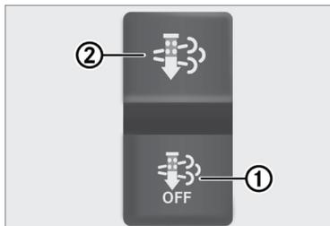
Caso as altas temperaturas dos gases de escape, derivadas da regeneração automática, apresentarem algum perigo, ou seja, quando o calor produzido colocar em risco a segurança do veículo, é possível bloquear o processo de regeneração automática, pressionando a parte inferior do interruptor 1.
