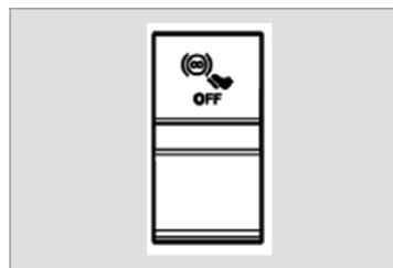
Pressione a parte superior do interruptor do freio motor (comando do freio motor pelo pedal do freio - desligado). O comando do freio motor é desativado.
