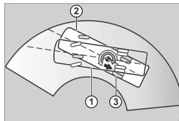
O eixo dianteiro do veículo desvia-se de sua trajetória (1) para a parte central da pista (2). A frenagem seletiva da roda traseira mais próxima (3) corrige a estabilidade do veículo.
