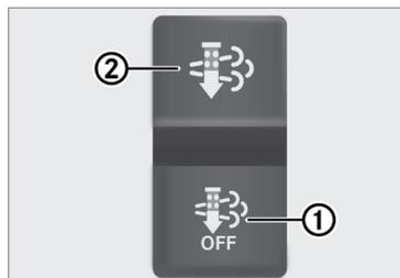
Para desativar o bloqueio, pressione a parte inferior (1) do interruptor novamente.
