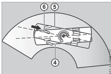
O veículo “escapa” no eixo traseiro. O veículo desvia-se de sua trajetória (4) e gira para o centro da pista (5). A frenagem seletiva da roda dianteira mais próxima (6) corrige a estabilidade do veículo.
