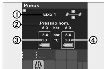
(1) Indicação do eixo 1. Para navegar para o eixo 2, acione os botões no volante.
