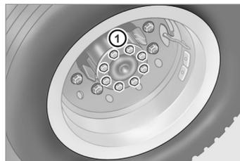
(1) Parafusos de fixação do semieixo no cubo de roda (exemplo)
