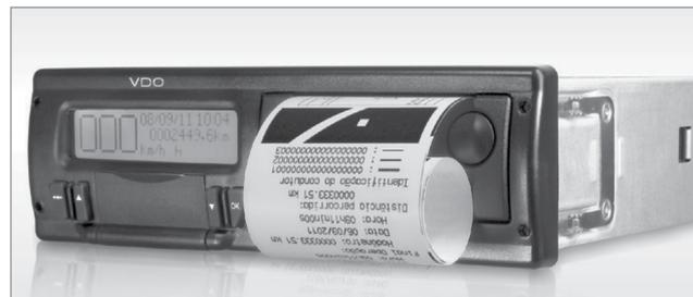
Com este dispositivo obtém-se um prospecto da velocidade do veículo em função do tempo, essas informações são visualizadas através da saída de dados em impressão de fita diagrama, não utilizando mais o disco.
