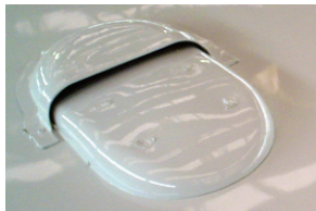
Entrada de ar pelo teto, parte externa do veículo.
