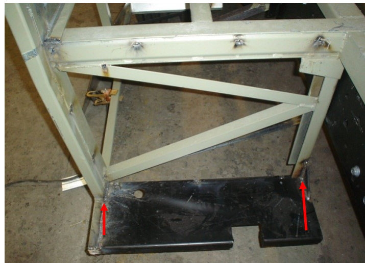
Figura 8 - Indicação dos pontos de fixação da base.
