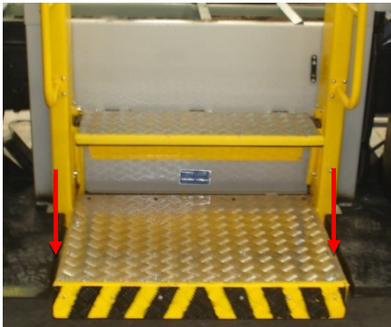
Figura 16 - Pontos de vedação da plataforma com a base da carroceria. Figura 17 - Pontos de vedação da plataforma com a base da carroceria.
