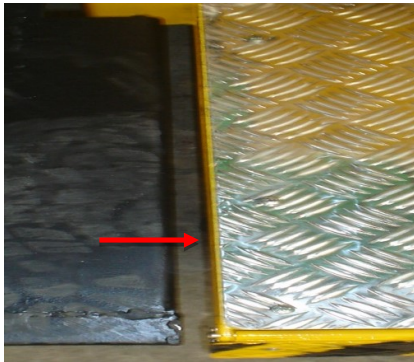
Figura 16 - Pontos de vedação da plataforma com a base da carroceria. Figura 17 - Pontos de vedação da plataforma com a base da carroceria.
