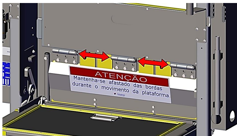
Figura 28 - Indicação dos pinos de dobradiça a serem lubrificados.
